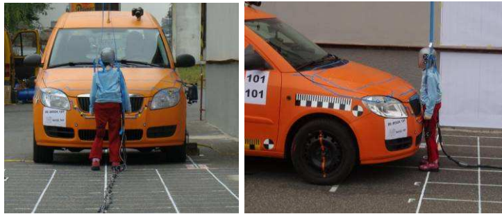
Obr. 1 - Pozice figuríny vzhledem ke kolidujícímu vozidlu
