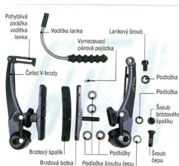
Obrázek 24 Brzdy typu V
