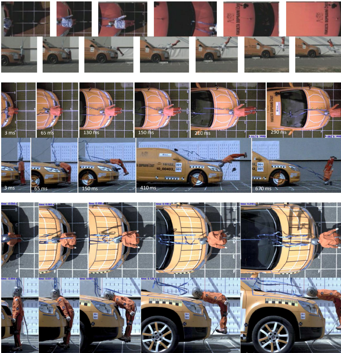
Obrázek 39 – Průběh kolize v místě střetu, 30 km/h, shora Roomster – Octavia – Yeti [5,6,7]
