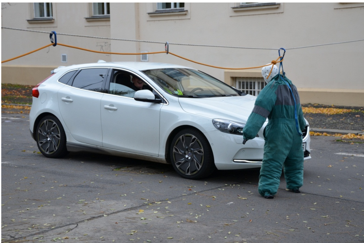
Obrázek 42 – Jdoucí figurína, místo středu PP roh, auto detekuje a nebrzdí
