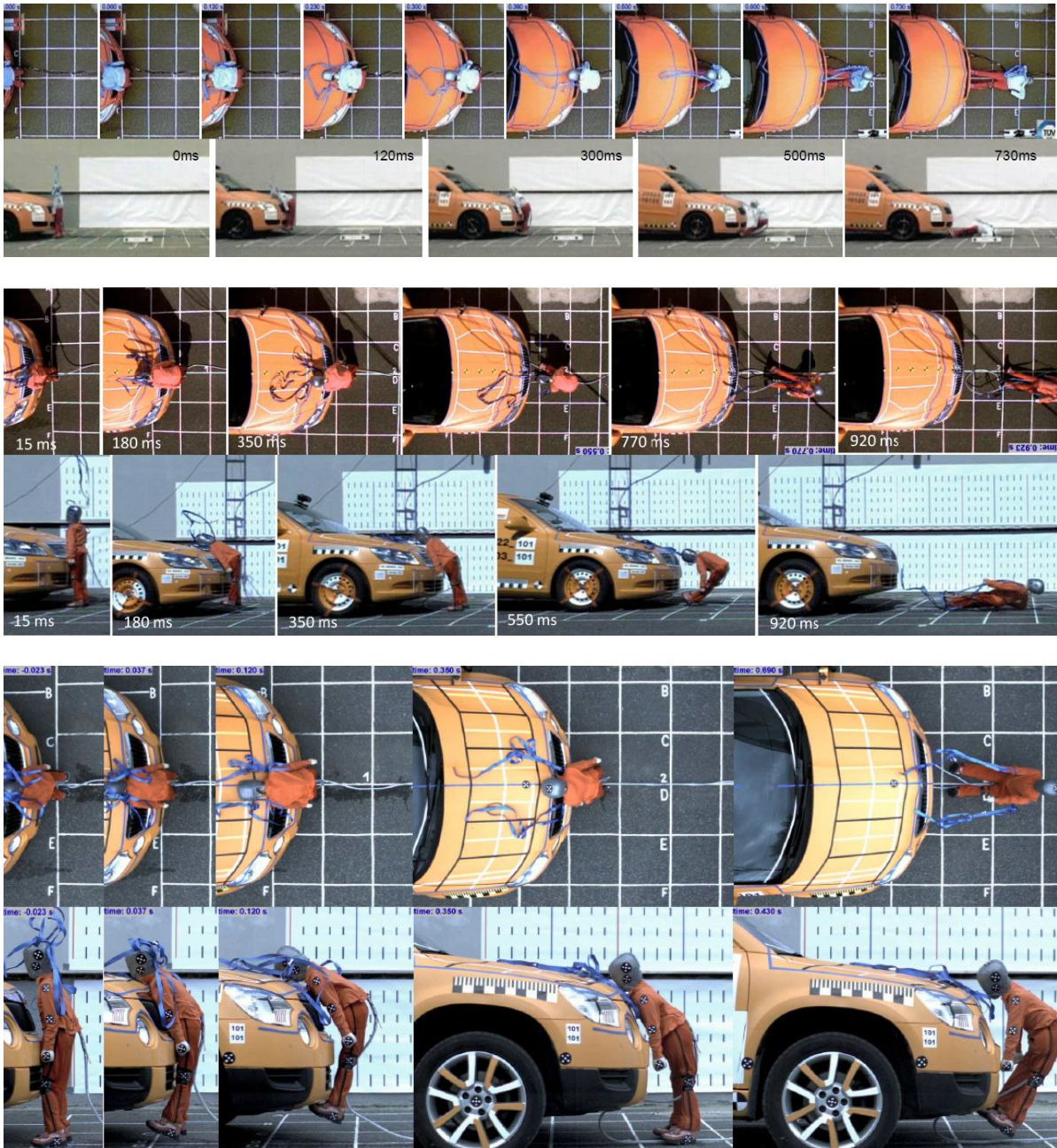
Obrázek 35 – Průběh kolize v místě střetu, 10 km/h, shora Roomster – Octavia – Yeti [5,6,7]
