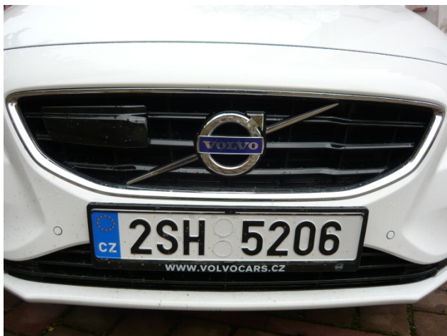
Obrázek 32 – Radar na přídí
