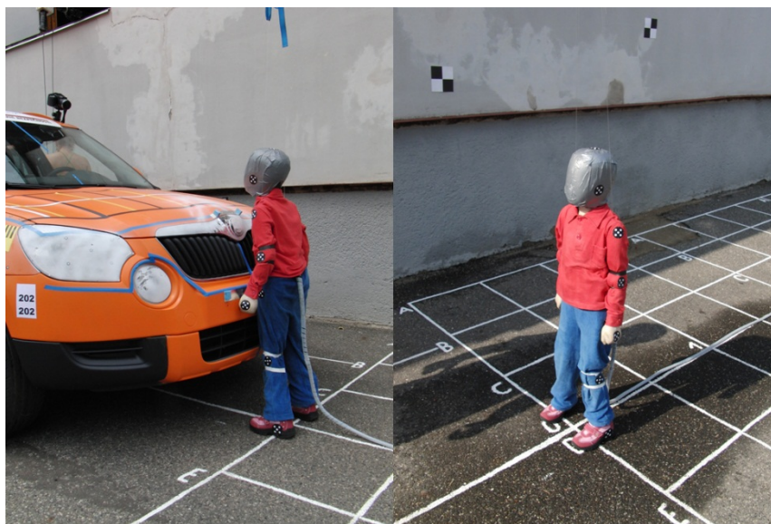
Obrázek 24 – Základní pozice figuríny čelem proti směru jedoucího vozidla
