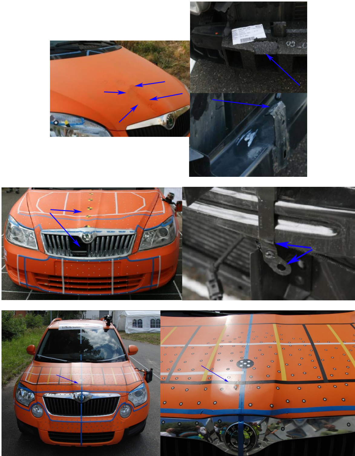
Obrázek 40 – Stav automobilů po kolizi, shora Roomster, Octavia, Yeti
