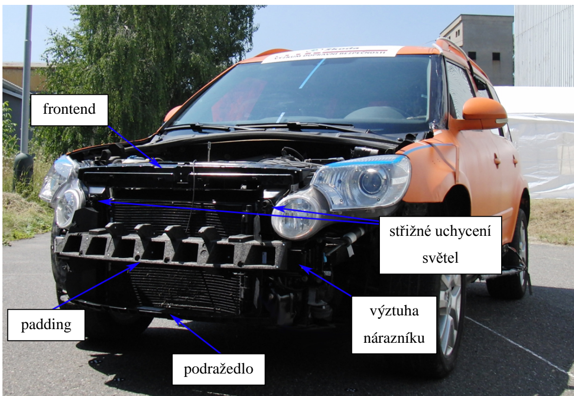
Obrázek 6 – Skladba bezpečnostních prvků na přídě vozidla SUV
