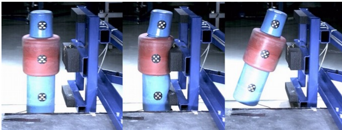
Obrázek 23 – PDI impaktor vyvinut pro systém detekce chodců [3]
