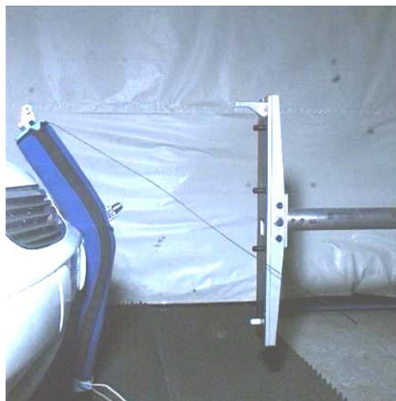
Obrázek 22 – Impaktor dolní končetiny
