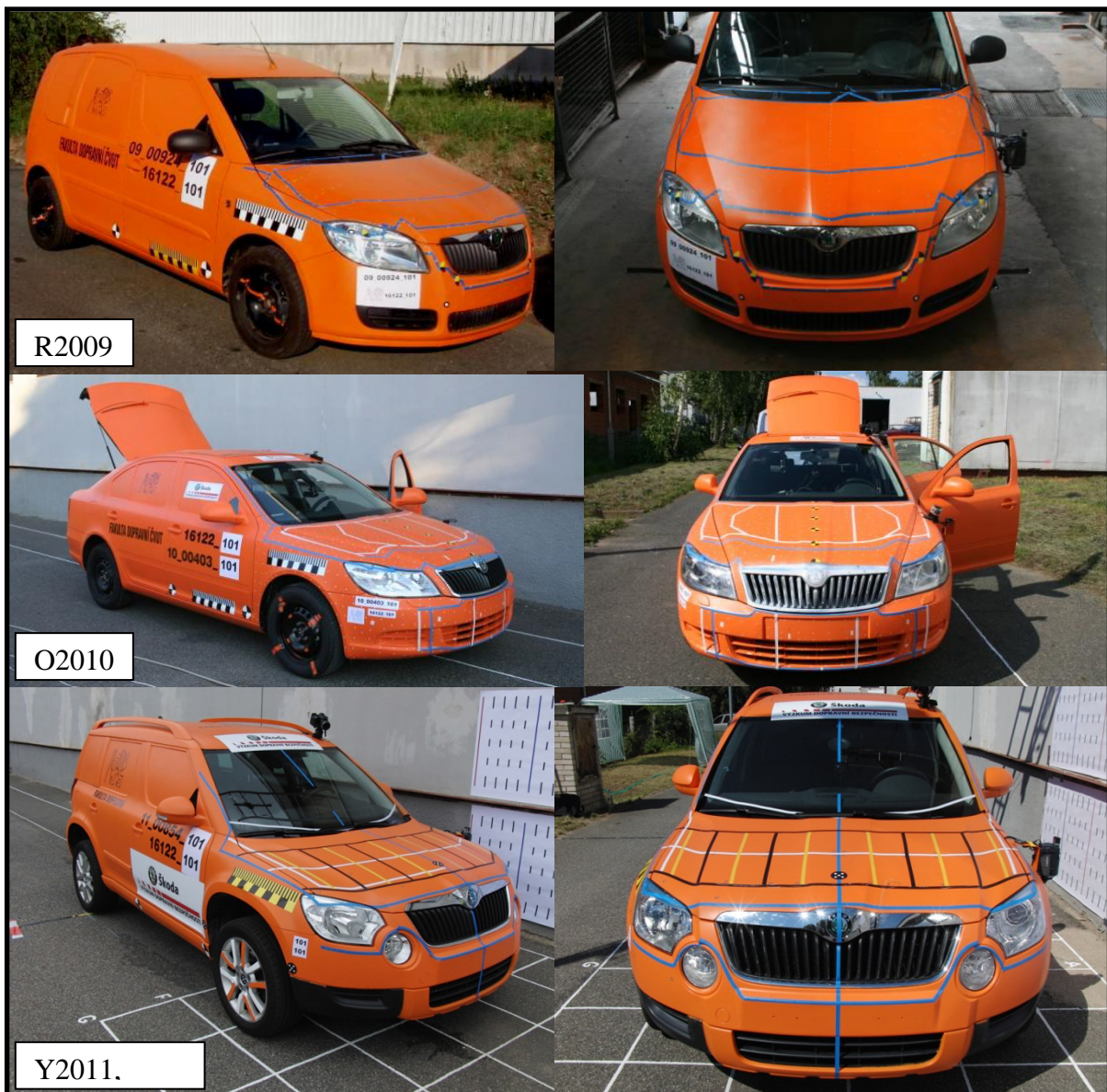
Obrázek 28 – Zóny na předích automobilů při testech R2009, O2010, Y2011, Y2012
