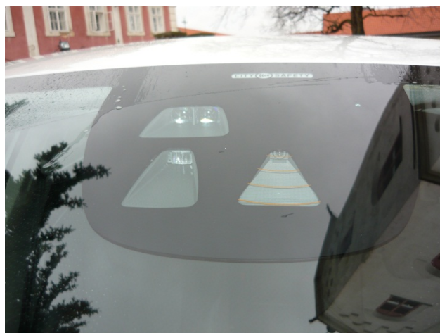
Obrázek 31 – Kamera, vysílač a přijímač signálu laseru
