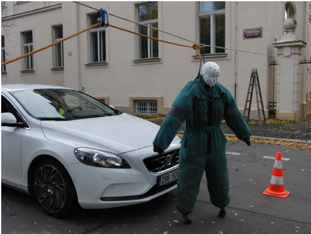
Obrázek 41 – Místo kontaktu vozidlo-figurína
