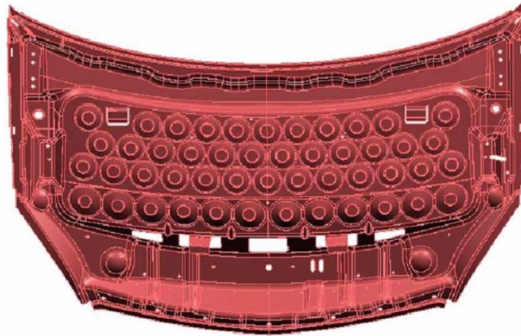
Obrázek 10 – Hliníková kapota s kužely [18]
