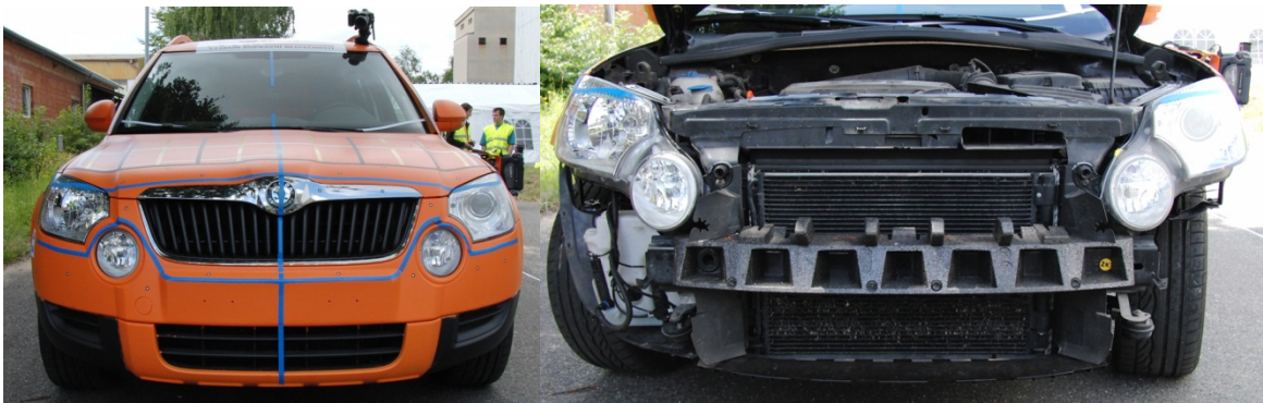
Obrázek 38 – Stav automobilů po kolizi, shora Roomster, Octavia, Yeti
