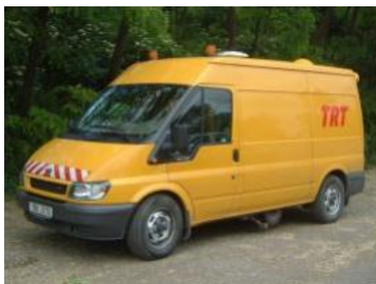
Obr. 29 – Nový Tatra Runway Tester (skříň Ford Tranzit) [19]
