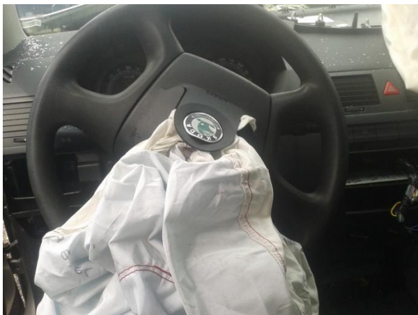
Obrázek 23 - poškození krytu volantu - Škoda
