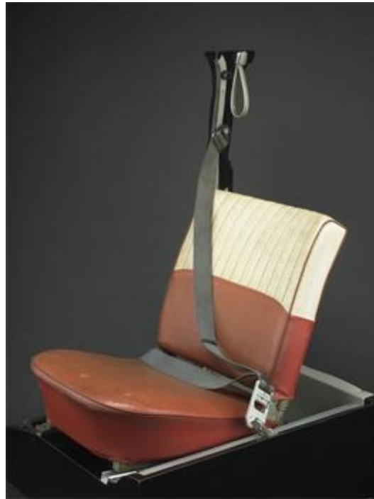
Obrázek 5 - původní třibodový pás automobilky Volvo [18]
