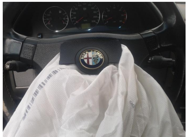
Obrázek 22 - poškození krytu volantu - Alfa Romeo
