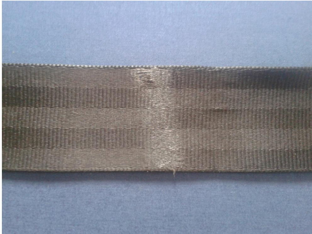
Obrázek 21 - Poškozená tkanina bezpečnostního pásu
