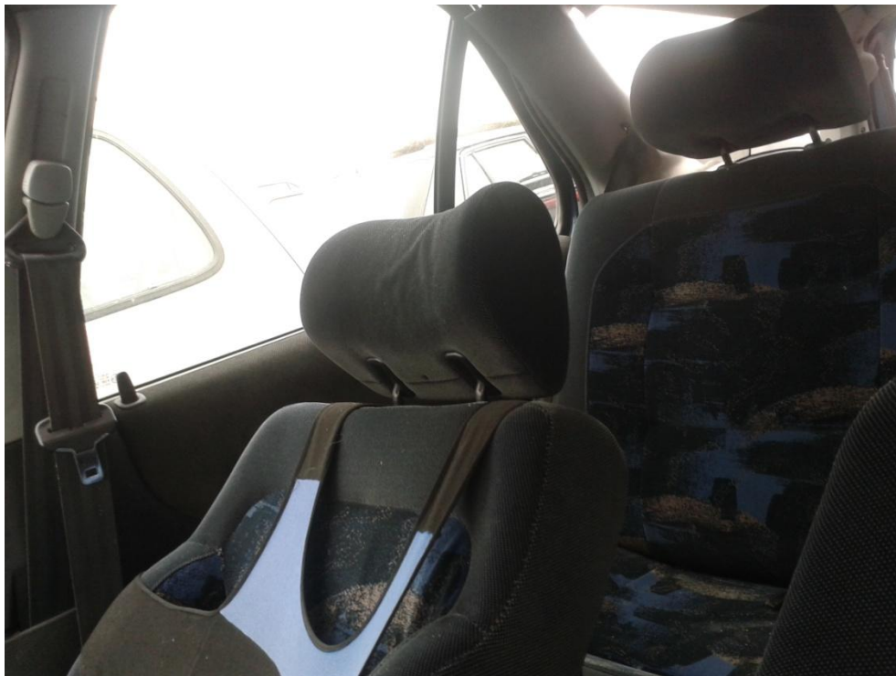
Obrázek 17 - stav sedadla a opěrky hlavy spolujezdce po nárazu zezadu
