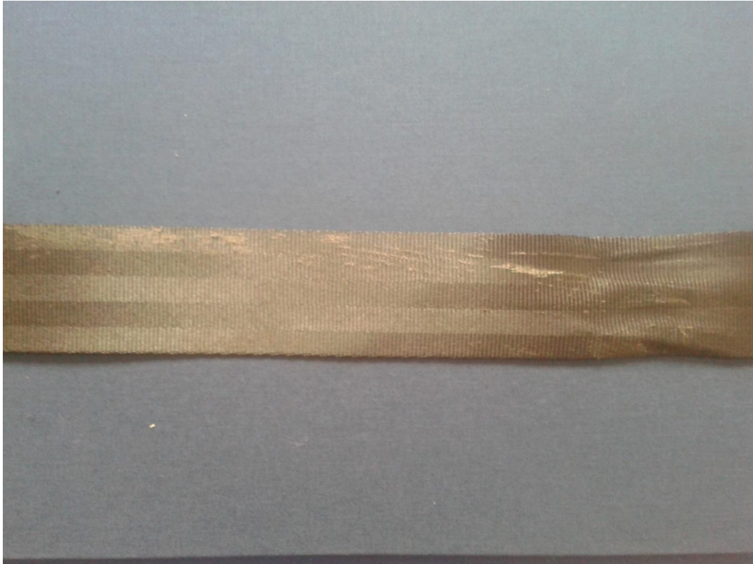
Obrázek 20 - poškození bezpečnostního pásu při čelním nárazu
