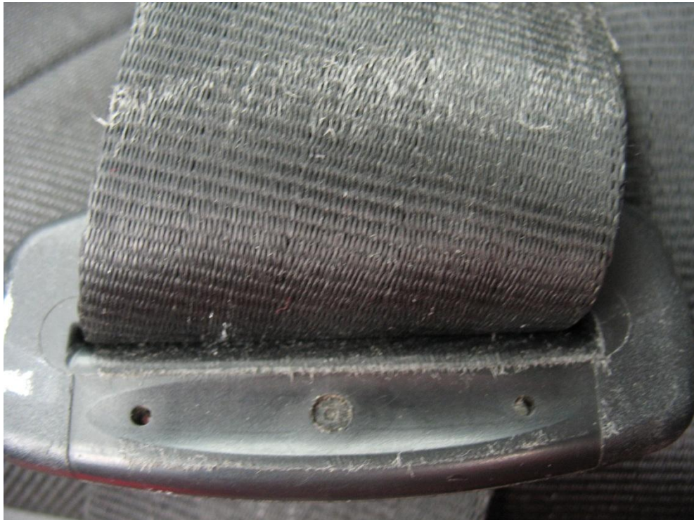
Obrázek 19 - poškození tkaniny pásu u spony
