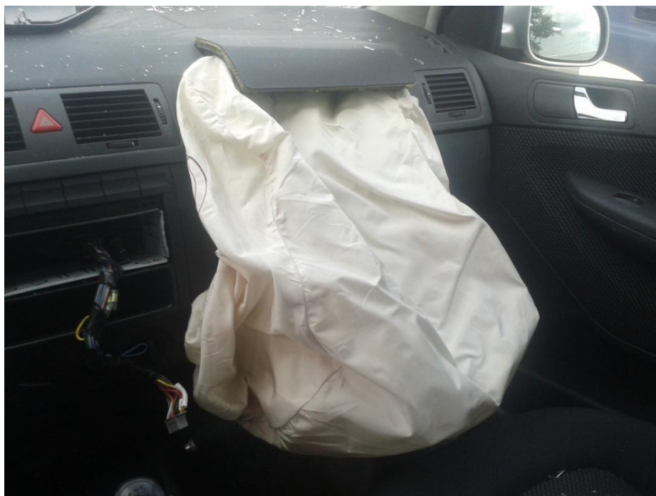
Obrázek 24 - vystřelený airbag spolujezdce s poničenou palubní deskou
