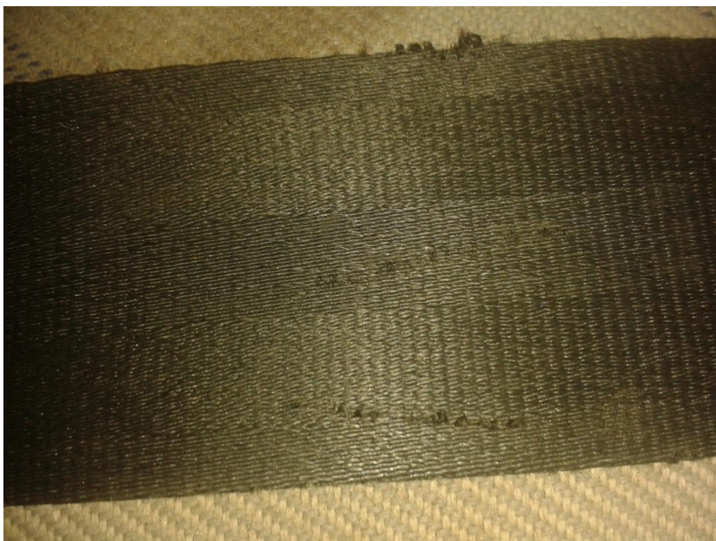
Obrázek 26 - opotřebení 2 - bodového pásu
