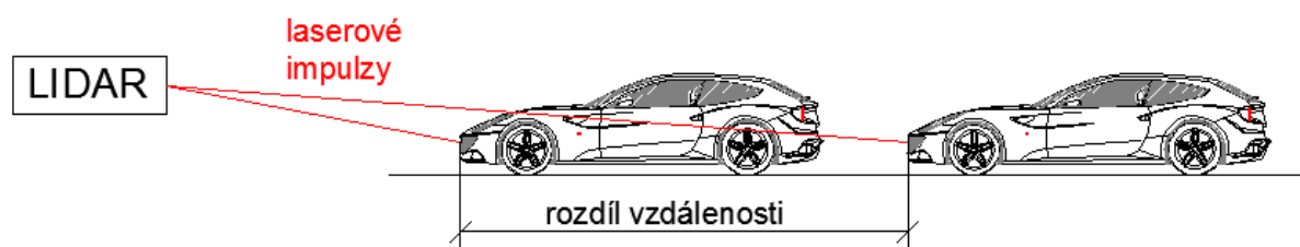
Obr. č. 15 - Princip laserového měřiče rychlosti
