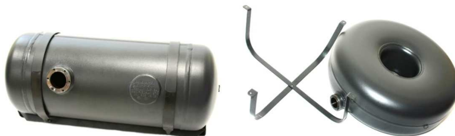
Obrázek 19 – Nádrže LPG (Válcová a toroidní pro umístění místo rezervního kola automobilu) [23]
