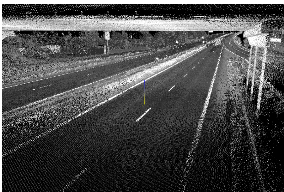
Obrázek 26: Mračno bodů kontinuálního prostorového skenování
