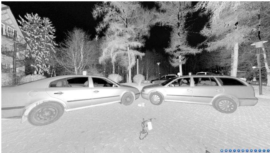
Obrázek 23: Použití 3D skeneru Faro Focus v praxi [13]
