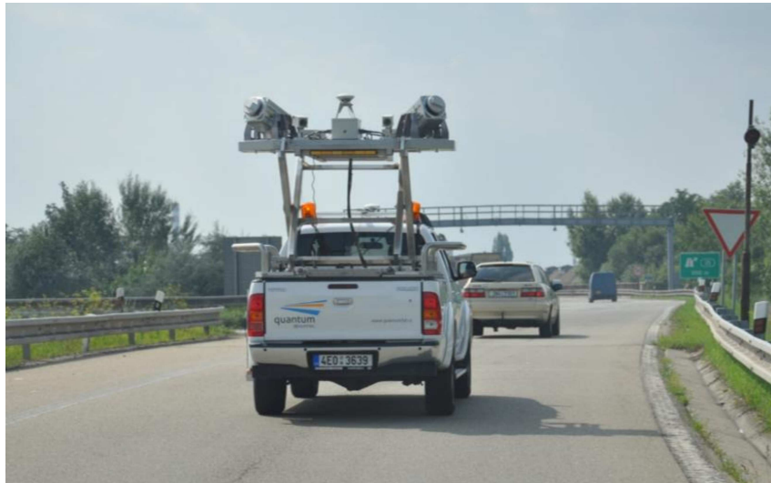
Obrázek 25: Skenování okolního terénu z jedoucího automobilu
