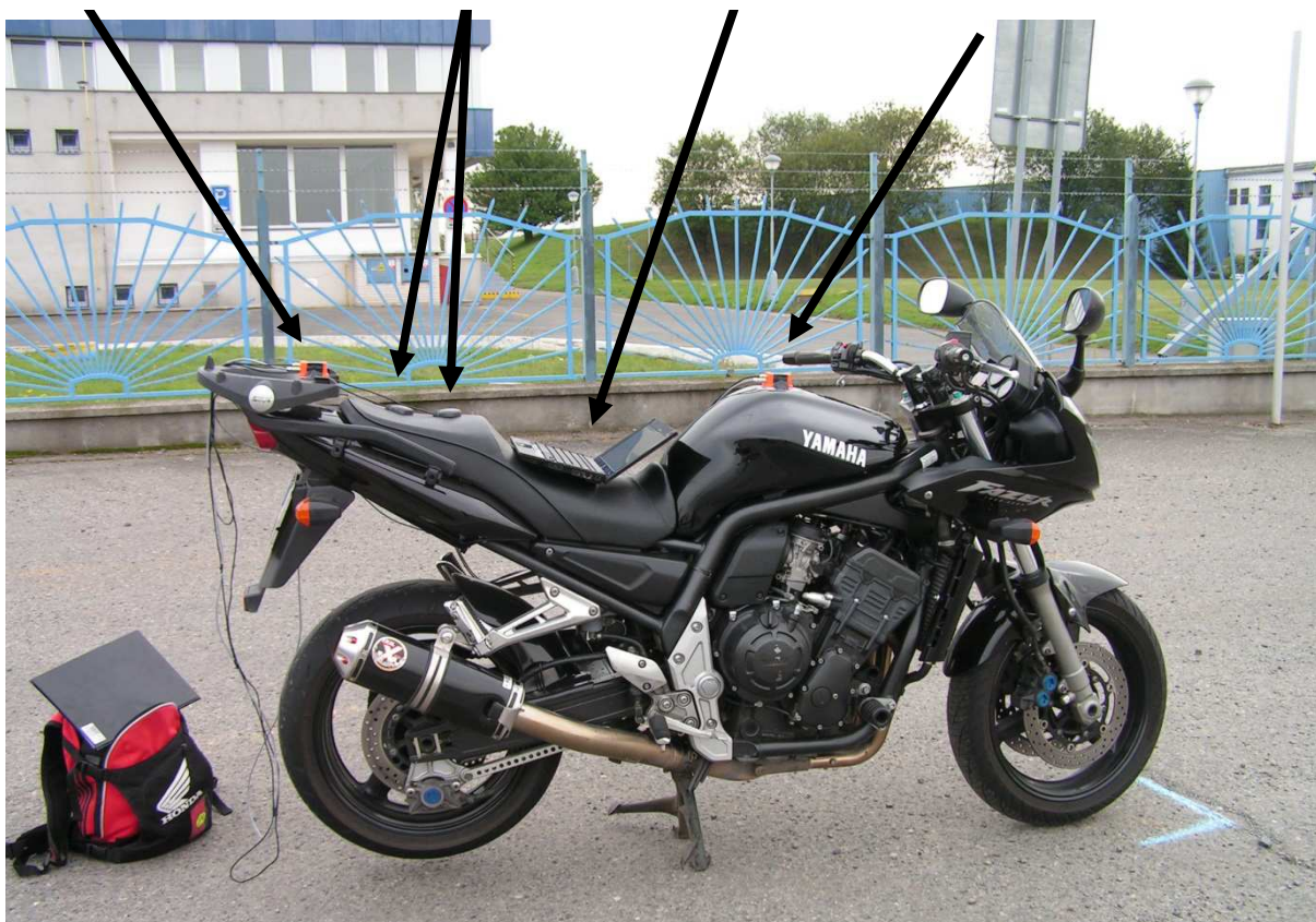
Obrázek 35: Umístění dvou snímačů XSENS MTi-G na motocyklu Yamaha FZS 1000 Fazer
