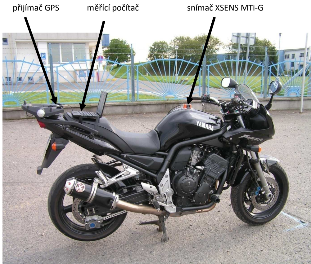
Obrázek 33: Umístění snímačů na motocyklu Yamaha FZS 1000 Fazer
