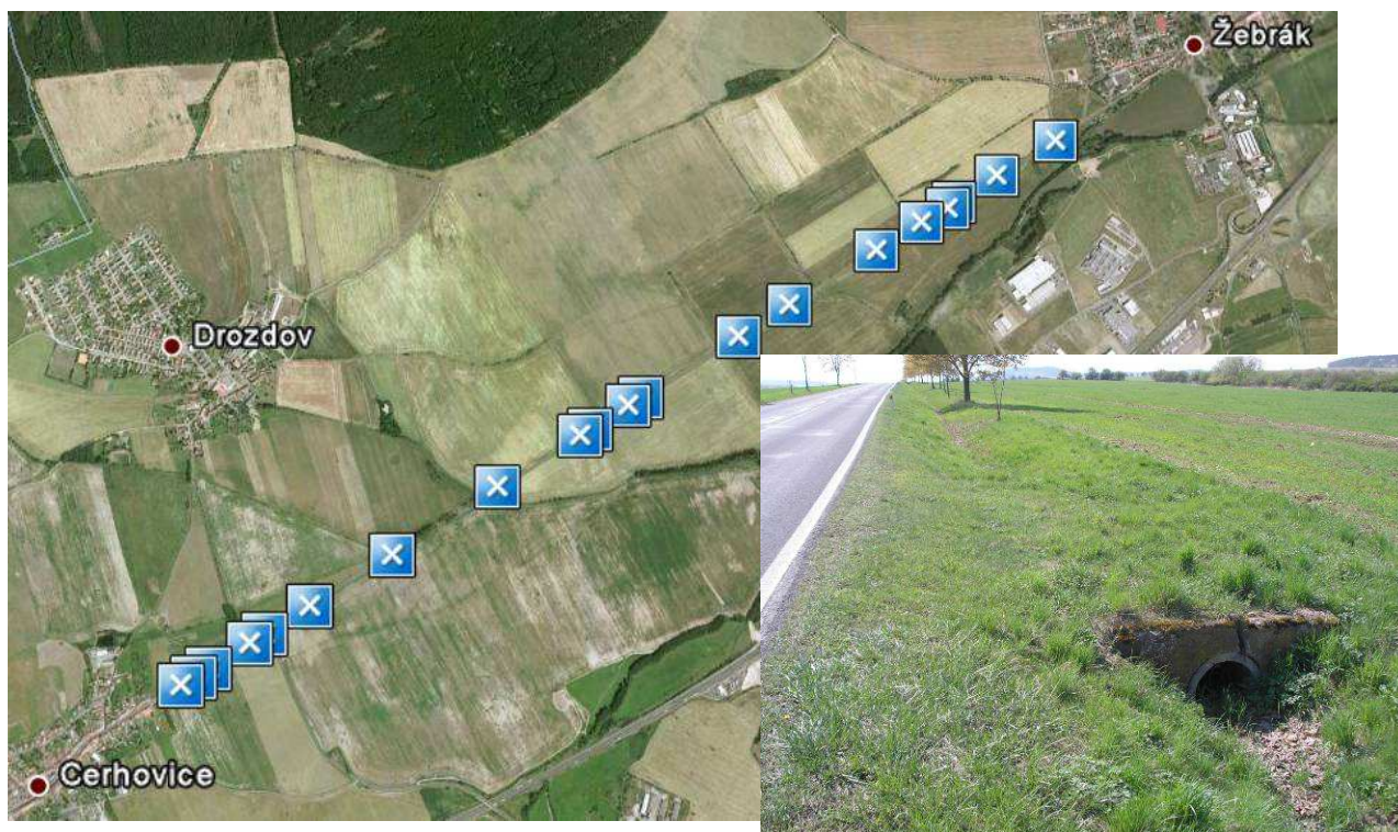
Obrázek 39 Rozmístění sjezdů na komunikaci II/605 v úseku Cerhovice – Žebrák, úsek 4,4 km (20)
