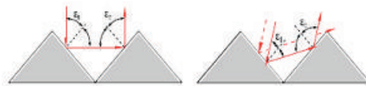
Obrázek 5.4. Dopadající světlo na odrazku se odrazí do stejného směru, ze kterého přišlo
