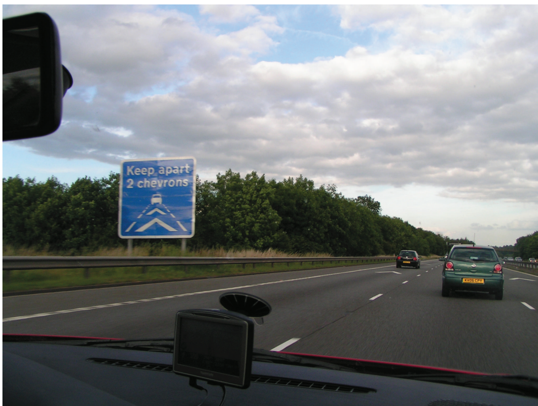
Obrázek 3.4. Značka vysvětlující postup odměření odstupu
