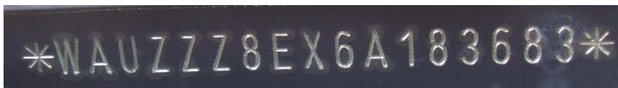
Obr. 35 - VIN ražené do jednoho řádku (AUDI)
