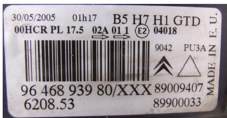
Obr. 25 - detail papírového identifikačního štítku dílu vozidla (CITROEN)
