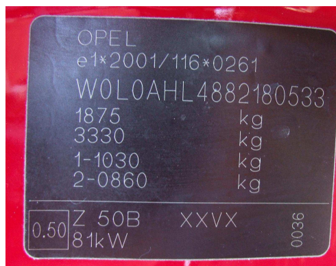
Obr. 21 - typový štítek (OPEL)
