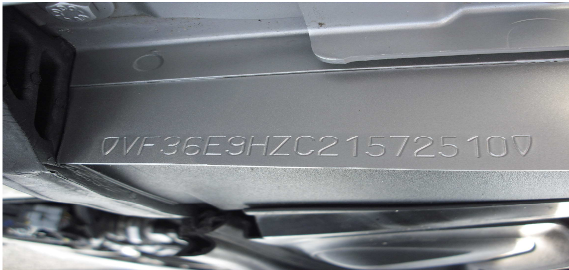
Obr. 41 - ražený VIN na daném vozidle (PEUGEOT)
