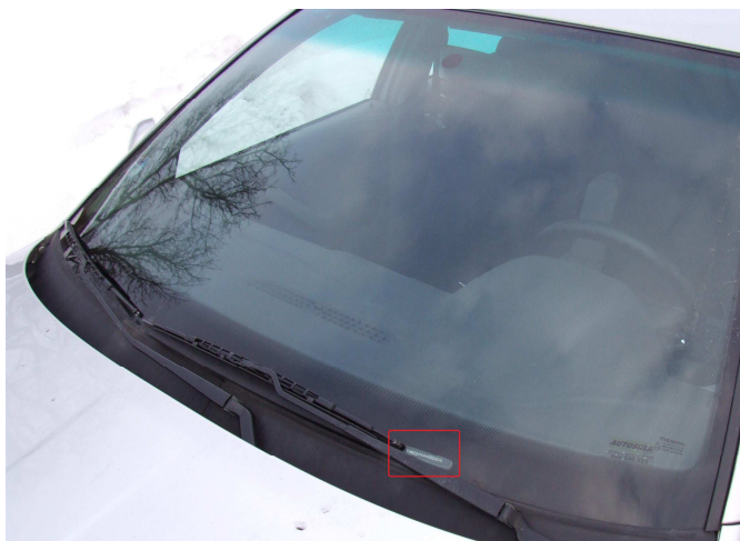
Obr. 12 - umístění VIN na vozidle (ŠKODA)
