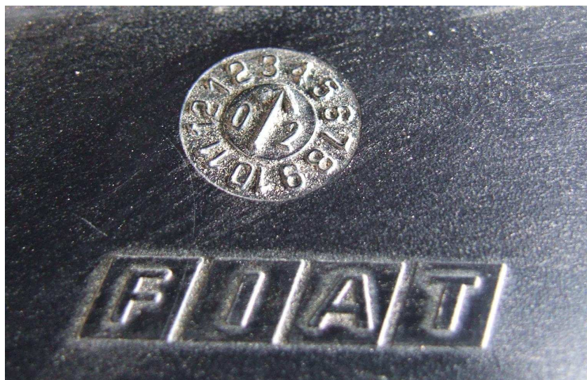
Obr. 44 - vyznačení data výroby, duben 2002
