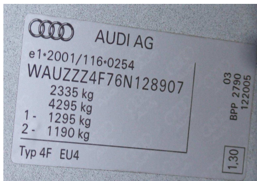
Obr. 20 - typový štítek (AUDI)
