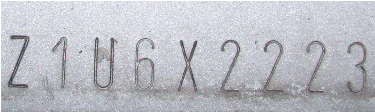
Obr. 37 - uzavřené znaky VIN (ŠKODA)
