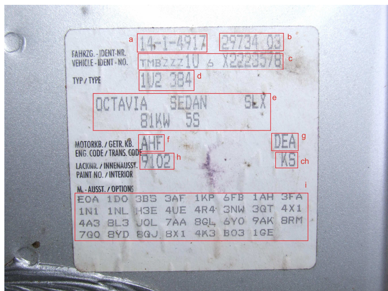
Obr. 19 - zákaznický štítek (ŠKODA)
