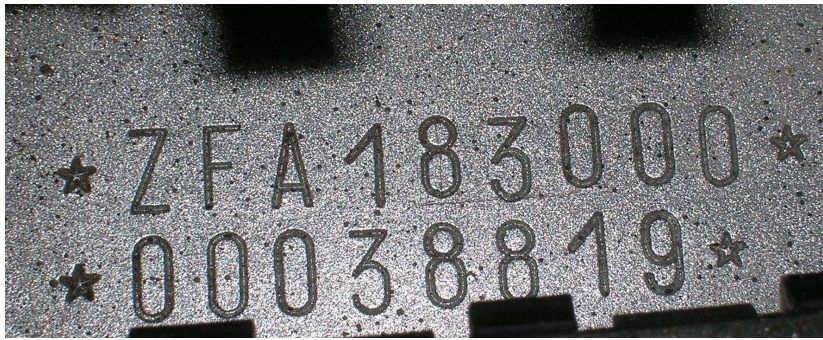
Obr. 36 - VIN ražené ve dvojřádkovém uspořádání (FIAT)
