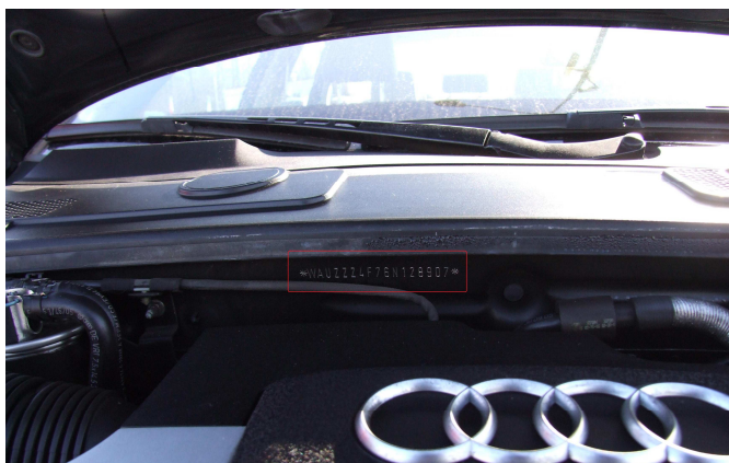
Obr. 13 - umístění VIN na vozidle (AUDI)
