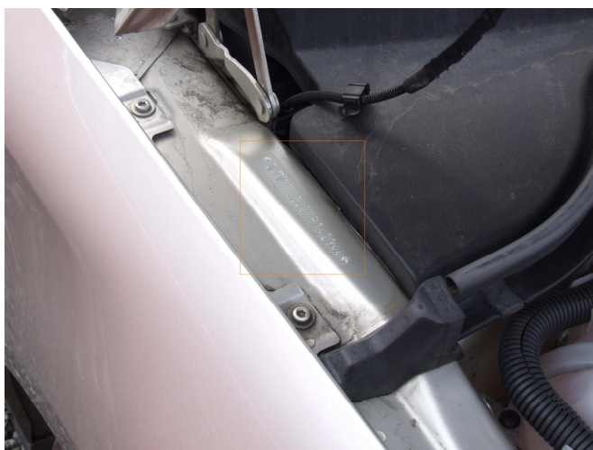
Obr. 14 - umístění VIN na vozidle (VOLKSWAGEN)
