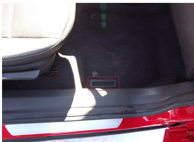
Obr. 16 - umístění VIN na vozidle (OPEL)
