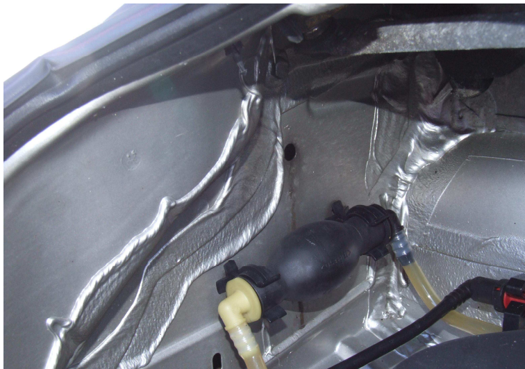
Obr. 27 - originální spojení dílů vozidla (ŠKODA)
