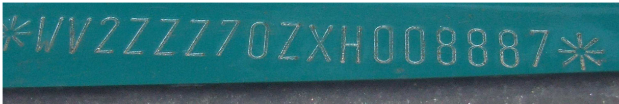
Obr. 2 - příklad VIN (VOLKSWAGEN)
