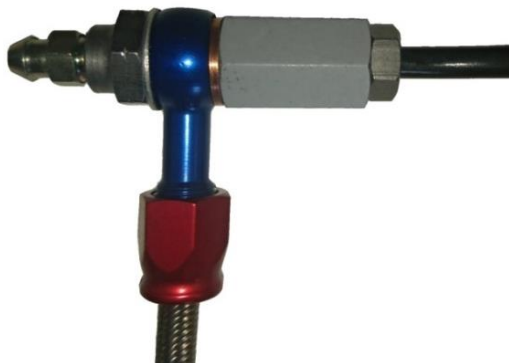
Obr. [61] Propojení brzdové hadice s brzdovou trubkou pomocí propojovacího šedého členu
