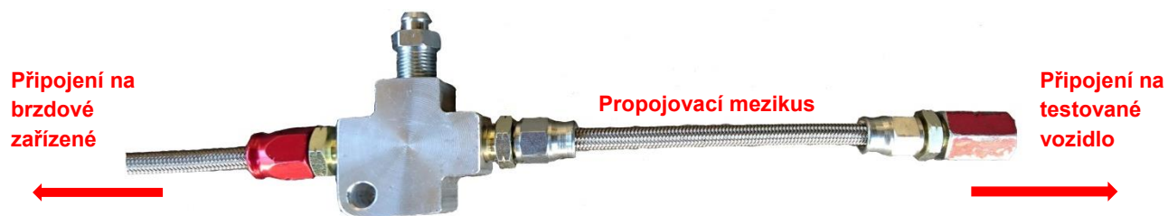
Obr. [66] Nově navržený přechodový díl
