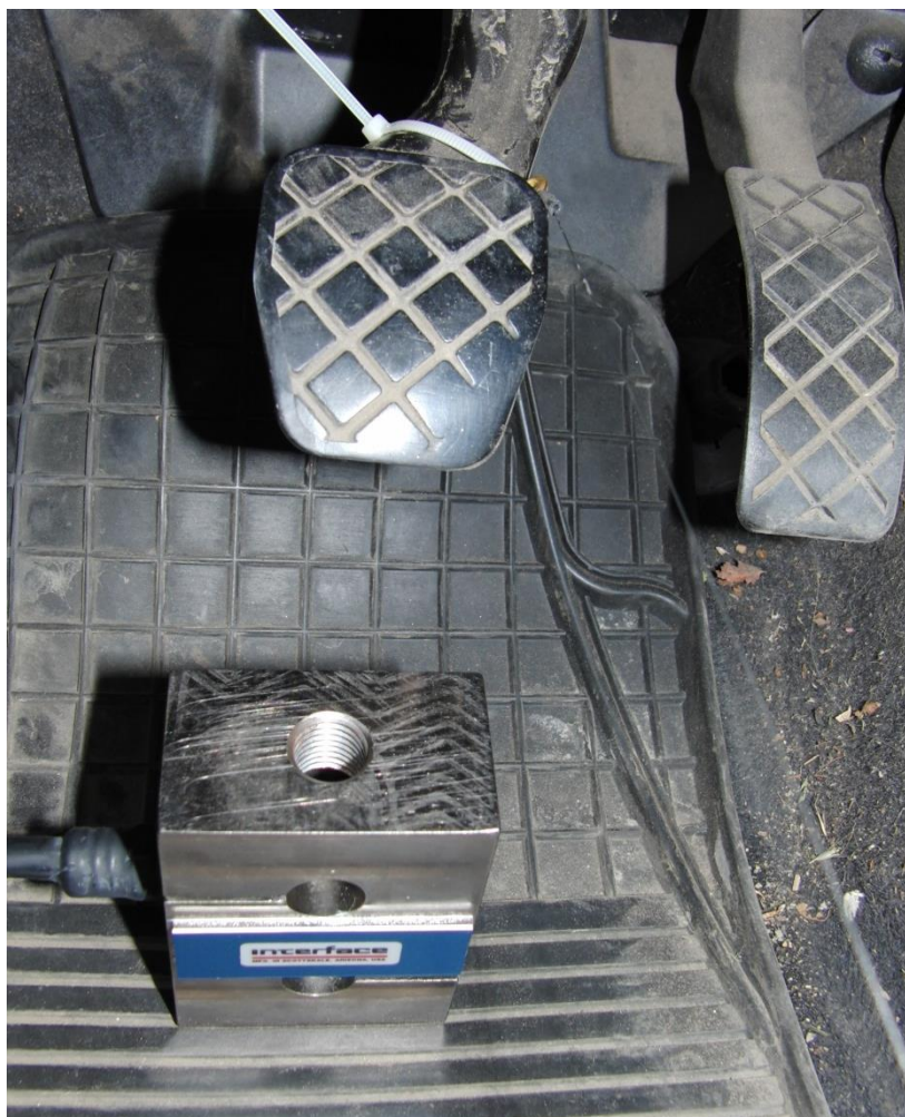
Obr. [39] Siloměr Interface SSM-20Kn při měření síly působící na pedál brzdy
