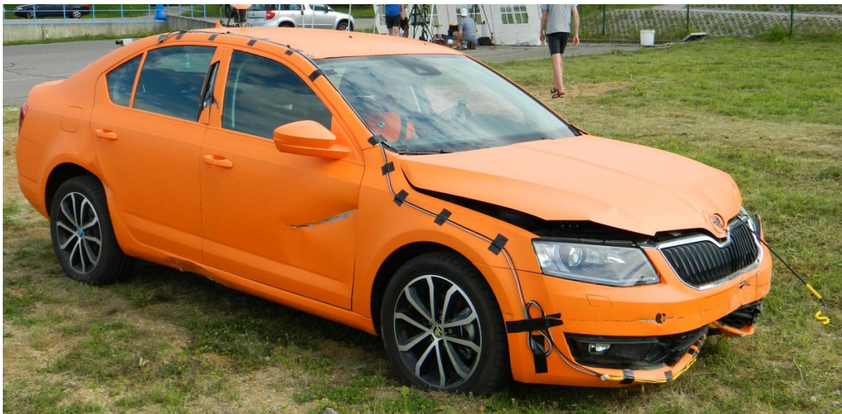
Obr. [60] Vedení pancéřové hadice a přívodních kabelů od snímače nárazu na testovaném vozidle během nárazového testu
