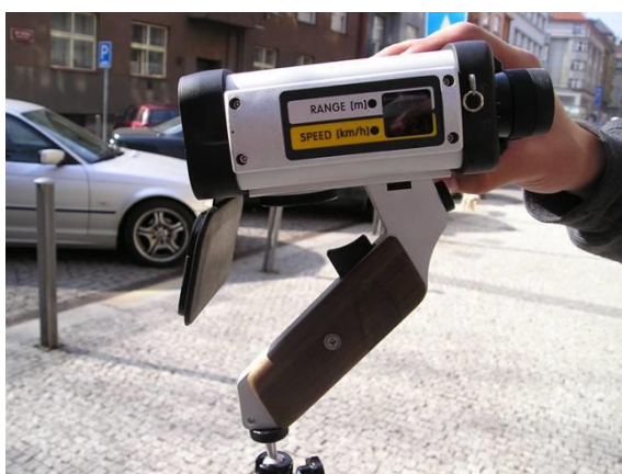
Obrázek 4: Laserový přístroj Riegl FG21-P pro měření rychlosti vozidel [6]
