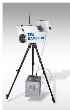
Obrázek 5: Radarový přístroj Ramer 10T pro měření rychlosti vozidel [7]
