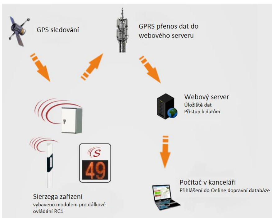
Obrázek 18: Princip přenosu dat do online databáze [24-upraveno]
