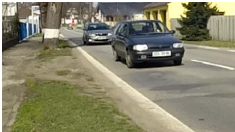
Obrázek 44: Vozidla jedoucí těsně za sebou jsou přístrojem zaznamenána jako jedno delší vozidlo
