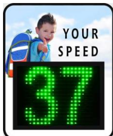
Obrázek 12: Rychlostní displej GR33L zobrazující aktuální rychlost projíždějících vozidel [17]
