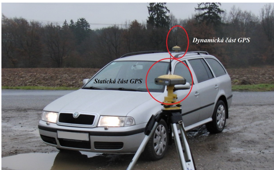
Obrázek 30 - Statická a dynamická část GPS
