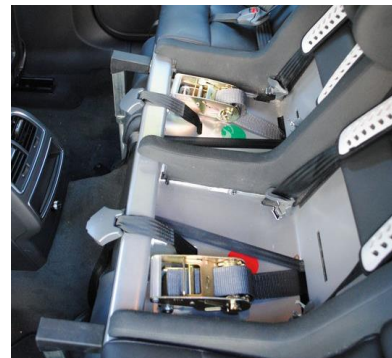
Obr. 22 Seřizovací ráčna pod polstrováním DZS Multimac [12]
