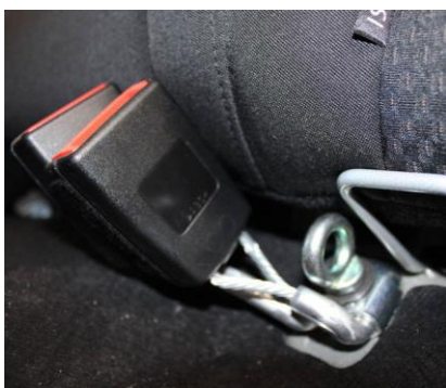
Obr. 20 Úchyt pro popruh připojený k montážnímu bodu zámků bezpečnostních pásů [12]
