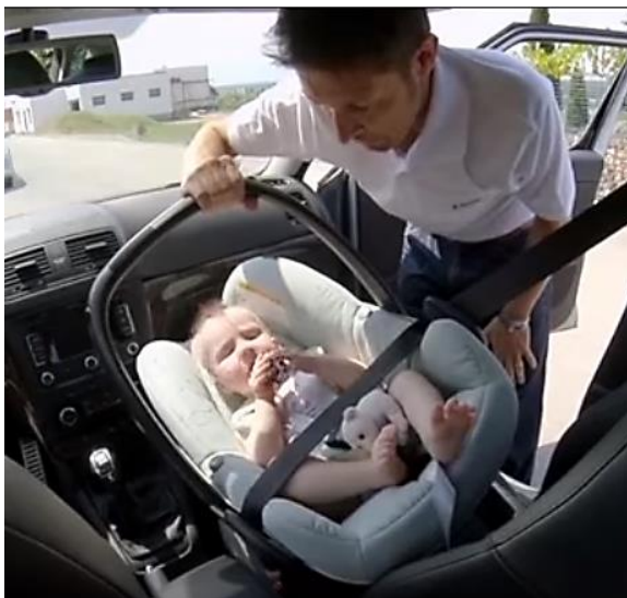
Obr. 34 Možnost rotace DZS při špatném vedení bezpečnostního pásu [26]
