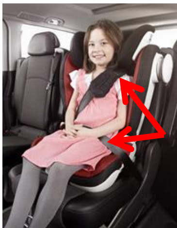
Obr. 41 Správně vedený bezpečnostní pás [38]
