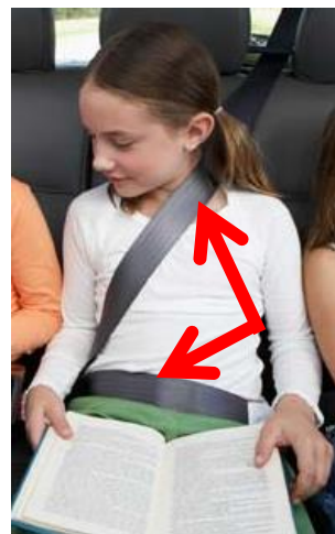
Obr. 42 Chybně vedený bezpečnostní pás [39]
