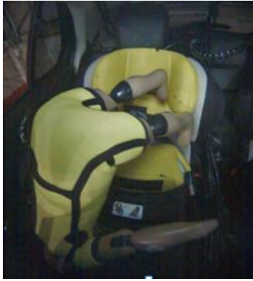
Obr.25 Vypadnutí figuríny Q1 z DZS během nárazové čelní zkoušky [10]
