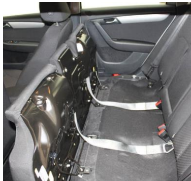
Obr. 21 Zadní sedadla s odejmutým polstrováním a popruhy Multimac [12]
