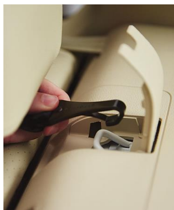
Obr. 32 Úchytný bod pro horní upínání (Top tether) [36]
