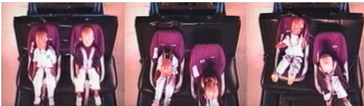
Obr. 33 Reakce pevně (vlevo) a volně (vpravo) instalovaného DZS při nárazu [25]
