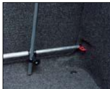
Obrázek 17: Způsob upevnění automříže [17], 2016
