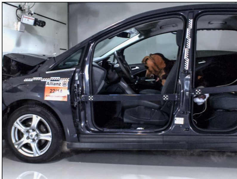
Obrázek 21: Záběr vymrštění nezajištěného psa při crash testu vysokorychlostní kamerou
