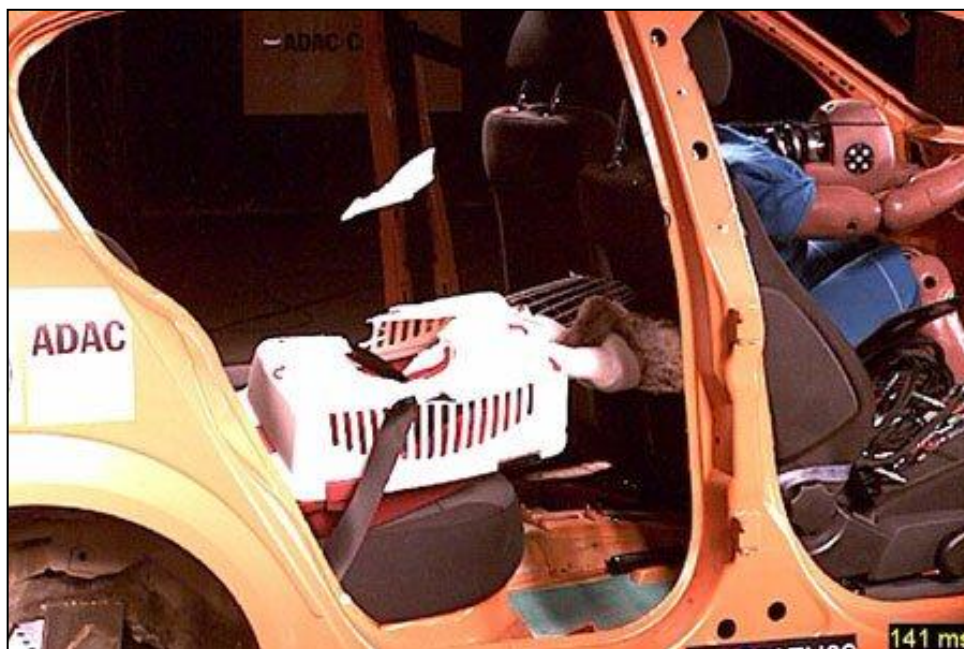
Obrázek 24: Záběr vysokorychlostní kamery crash testu při použití plastové přepravky [21],
