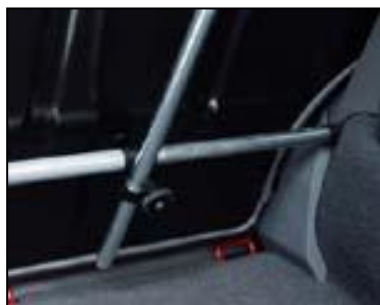
Obrázek 16: Způsob upevnění automříže [17], 2016
