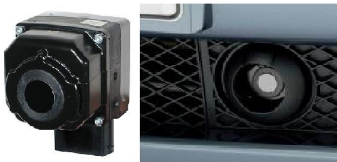
Obrázek 32 - Infrakamera, samostatný modul a příklad zabudování v nárazníku vozidla [28, 29]
