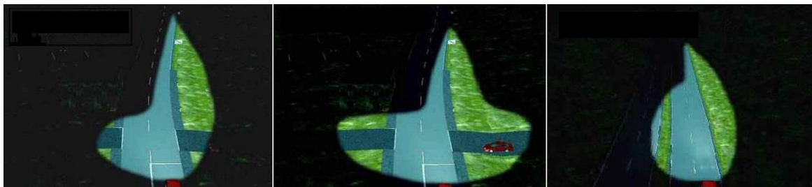
Obrázek 29 – Porovnání tlumeného (vlevo), městského (uprostřed) a dálničního světla (vpravo)
