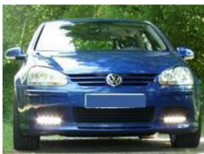
Obrázek 35 - Příklad zabudování LED diod pro denní svícení v předním nárazníku [32]
