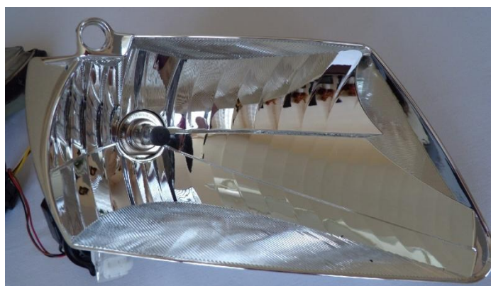
Obrázek 14 - Reflektor z vozu Škoda Roomster s jednotlivými segmenty – fazety
