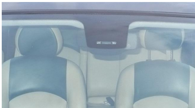
Obrázek 34 - Ukázka světleného senzoru na čelním skle osobního vozu Peugeot [30]
