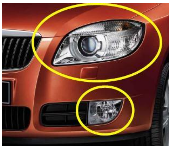
Obrázek 28 – Adaptivní dynamické světlomety u vozů Škoda Auto v kombinaci s projekčními světlomety s xenonovou výbojkou [26]
