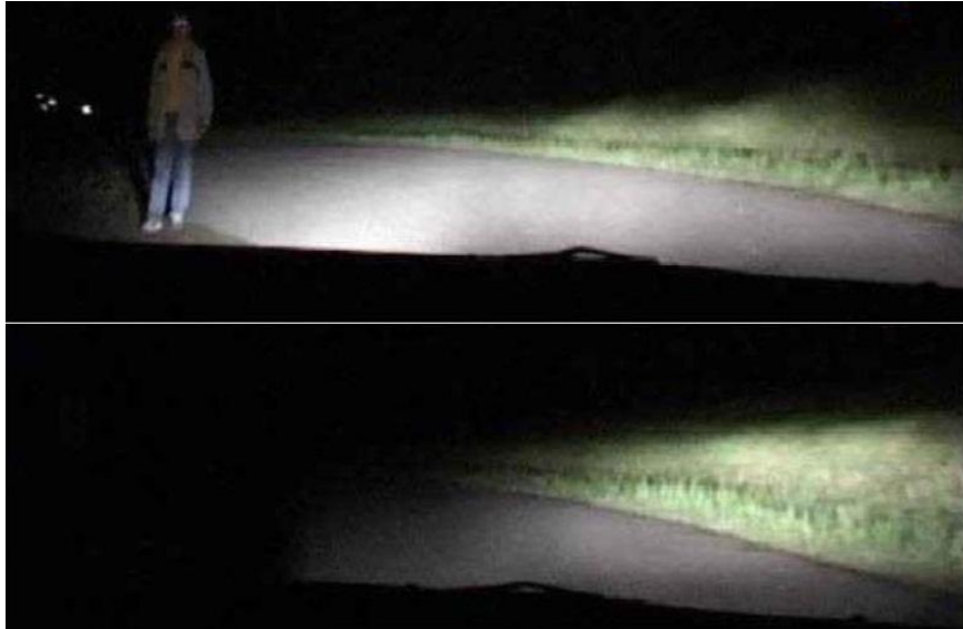
Obrázek 24 - Porovnání projetí zatáčkou s adaptivními (nahore) a klasickými (dole) světlomety [14]
