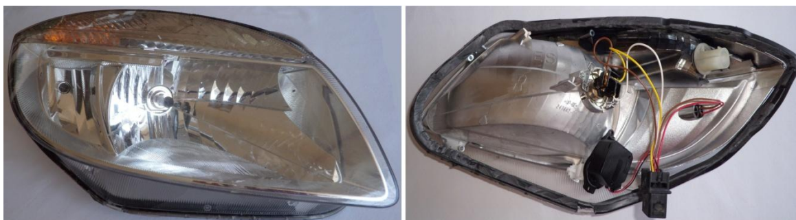
Obrázek 15 – Světlozet z vozu Škoda Roomster s reflektorovým světlozetem
