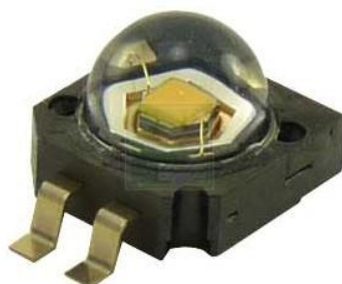
Obrázek 10 - První LED dioda pro přední světlomety (Luxeon K2 SMT) [14]
