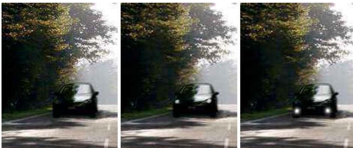
Obrázek 36 - Porovnání vozidel bez rozsvícených světlometů (vlevo), tlumených světlometů (uprostřed) a světel pro denní svícení (vpravo) [26]
