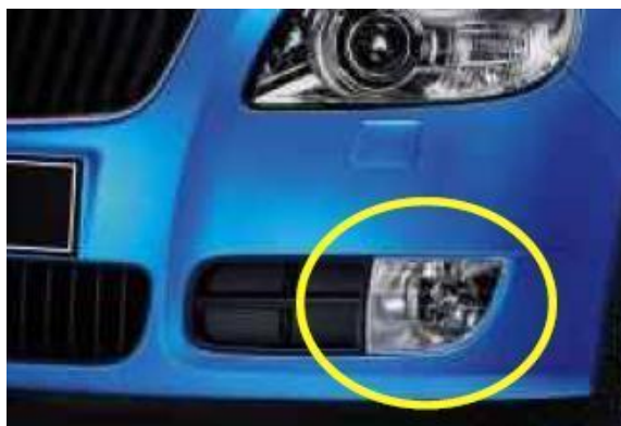
Obrázek 26 – Adaptivní statické světlomety u vozů Škoda Auto [26]
