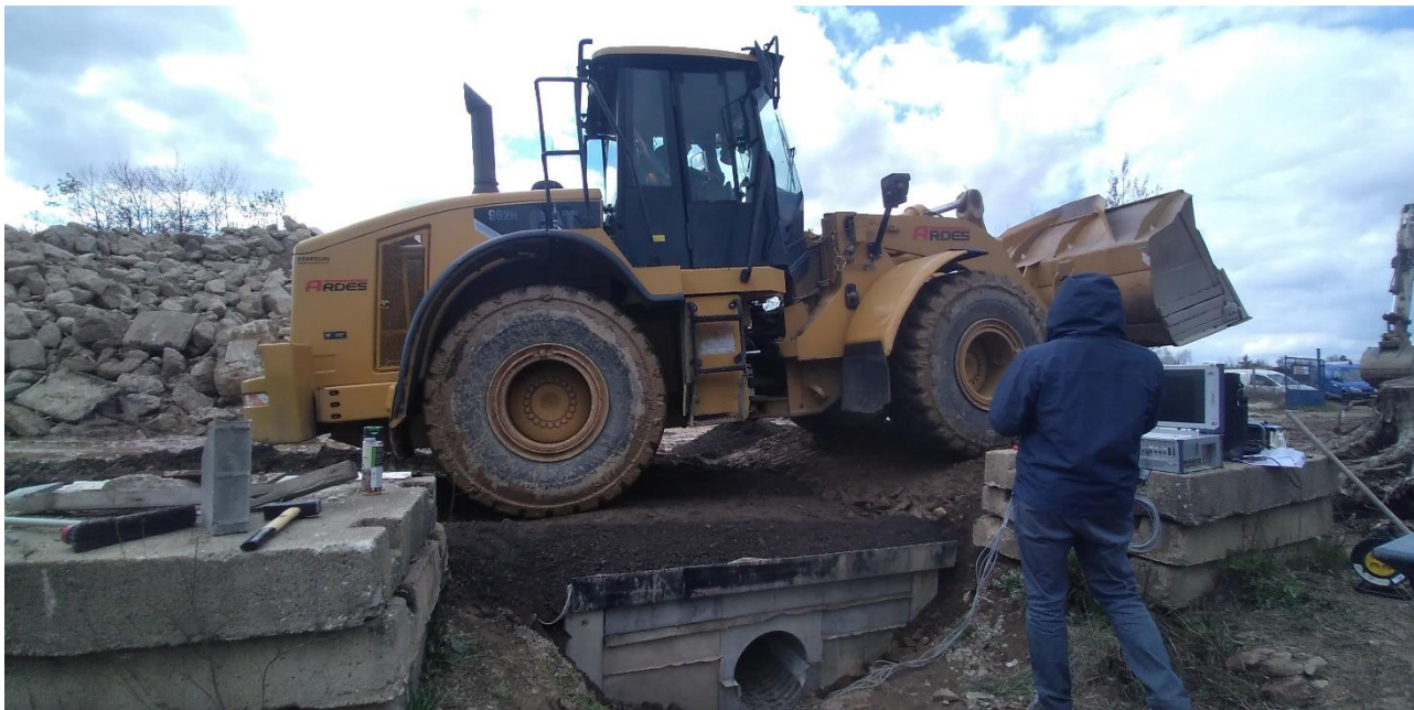
Obrázek 5: Nakladač Caterpillar 962H s prázdnou lžicí přejíždějící přes testovaný objekt složený z deformačních bloků.
