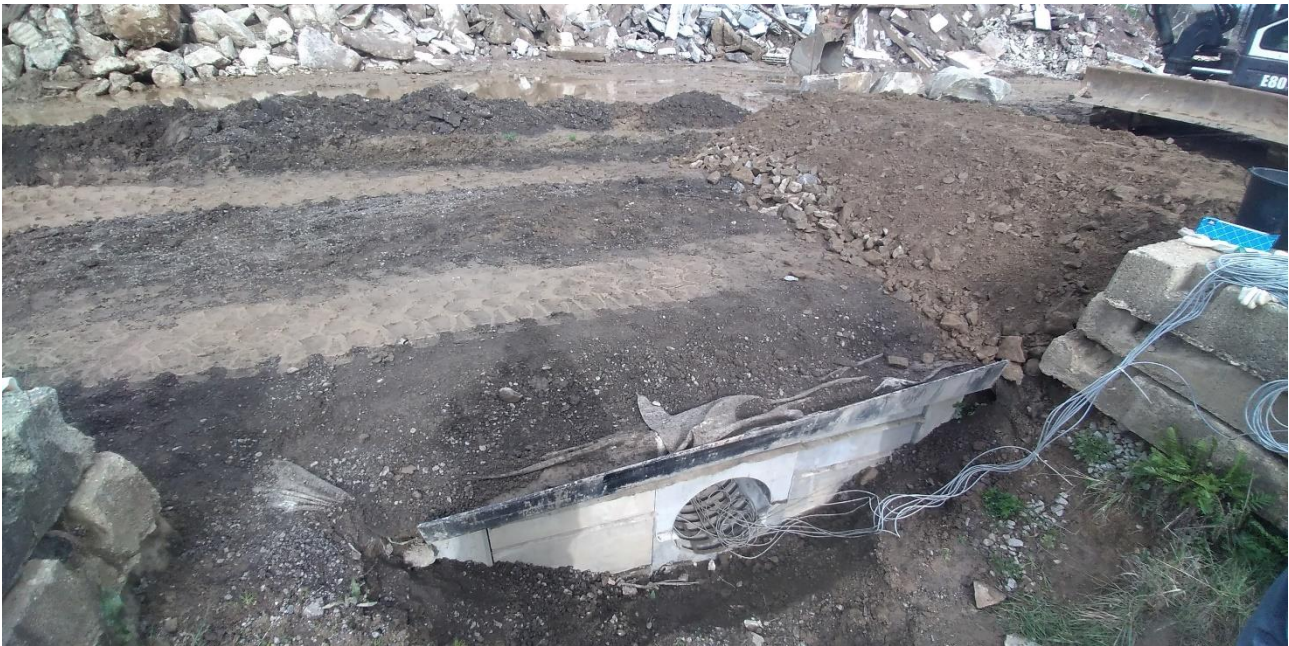
Obrázek 3: Bezpečnostní propustek složený z deformačních bloků a nainstalovaný na testovacím místě. Z otvoru pro průtok vody vedou ven kabely od tenzometrů do měřicí ústředny. Stav těsně před zátěžovými testy 26. dubna 2023.
