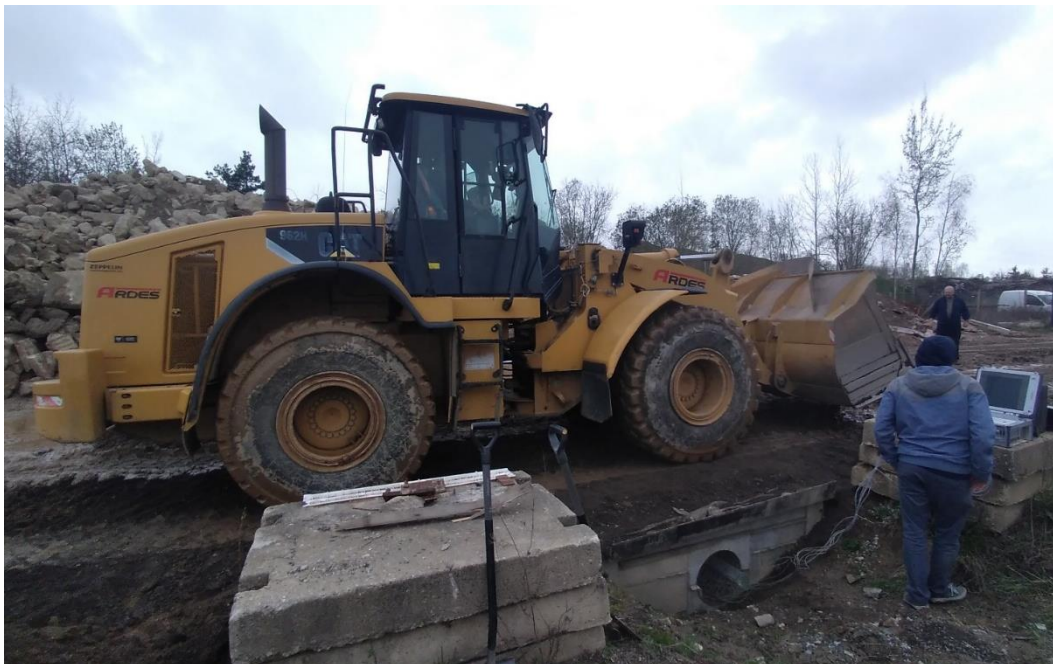
Obrázek 5: Nakladač Caterpillar 962H s prázdnou lžicí přejíždějící přes testovaný objekt složený z deformačních bloků, 26. dubna 2023.
