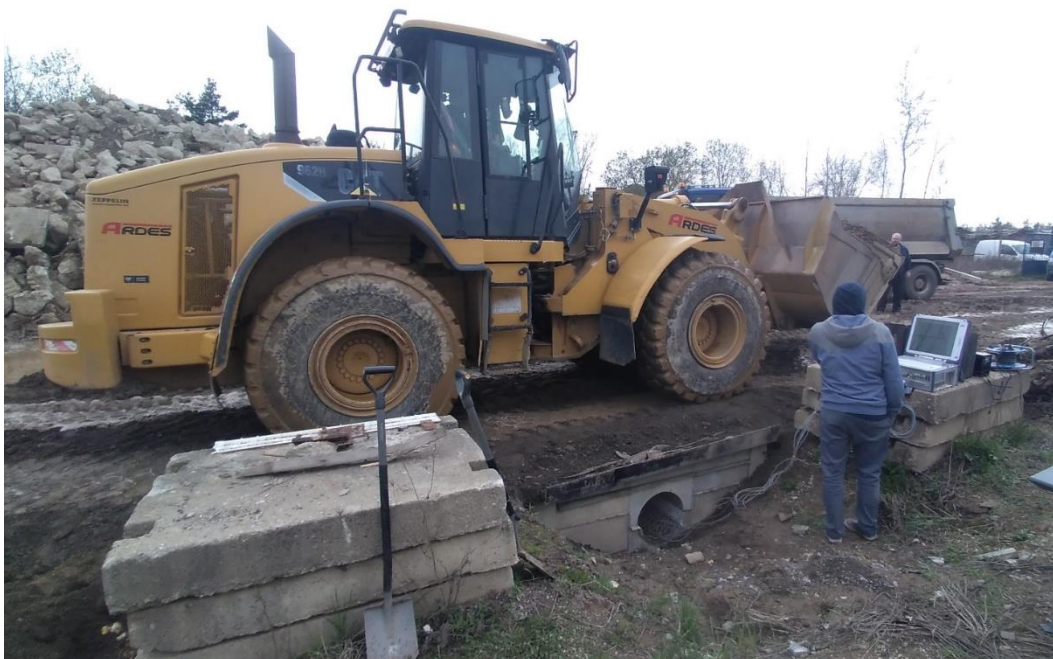
Obrázek 6: Nakladač Caterpillar 962H s plnou lžicí přejíždějící přes testovaný objekt složený z deformačních bloků, 26. dubna 2023.
