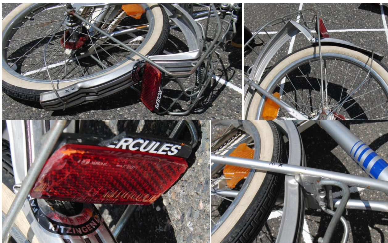
Obr. 9 – poškození jízdního kola po kolizi - 12_00905_301
