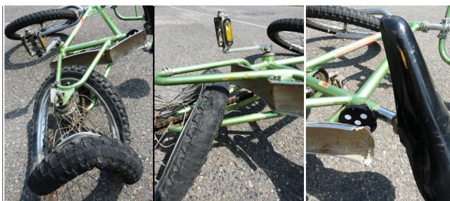
Obr. 17 – poškození jízdního kola po kolizi – test č. 302.
