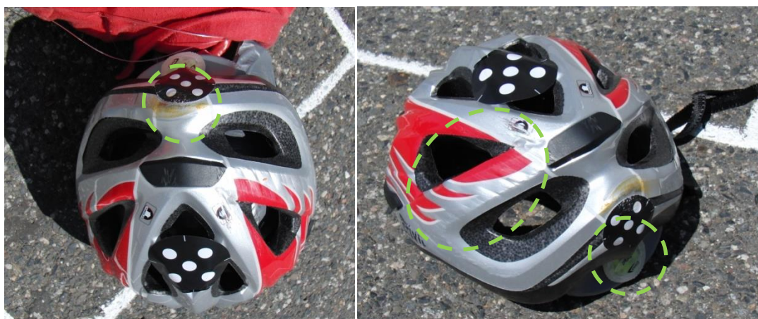
Obr. 8 – poškození cyklistické přilby po kolizi - 12_00905_301
