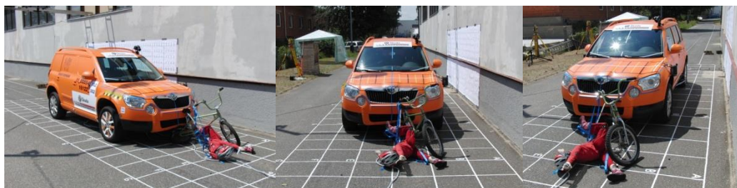
Obr. 15 - Konečná poloha objektů po testu č. 302 - fotodokumentace.
