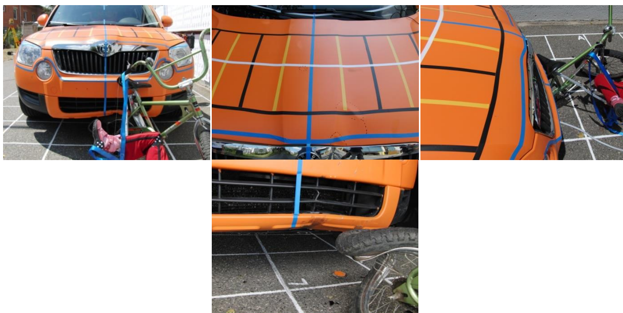
Obr. 16 - poškození automobilu po kolizi – test č. 302.
