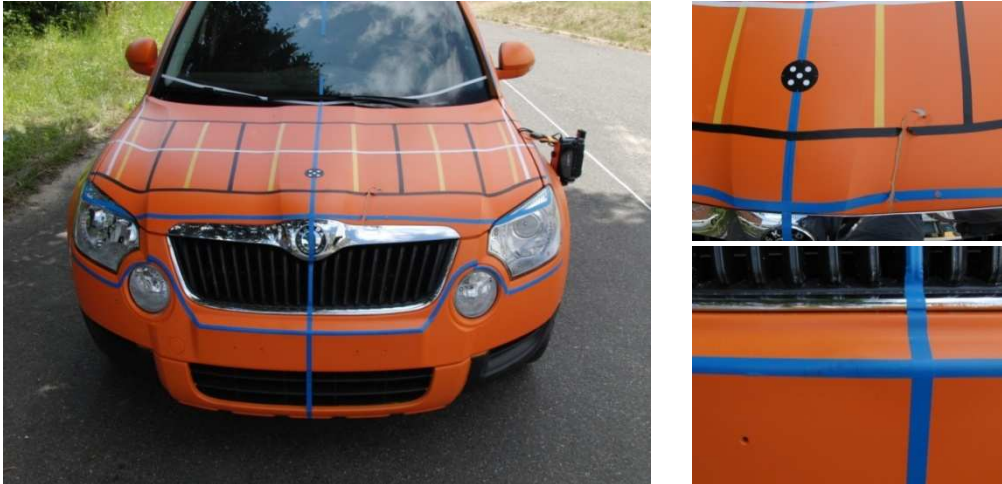
Obr. 22 – poškození automobilu po kolizi – test č. 202.
