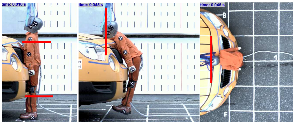
Obrázek 37 – střetová konfigurace figuríny P6 chodce s automobilem Škoda Yeti – vlevo první kontakt, uprostřed a vpravo – místo prvního kontaktu hlavy s kapotou.
