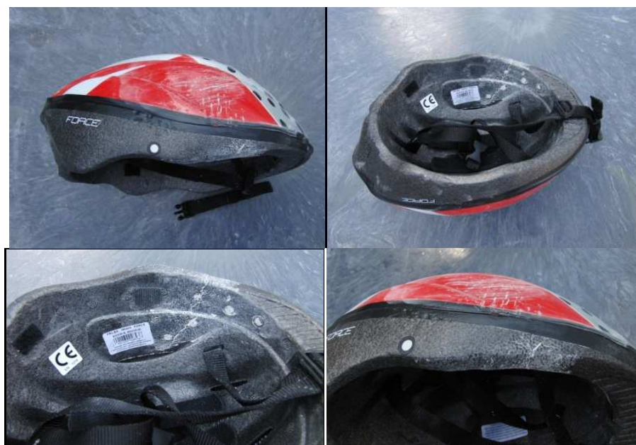
Obr. 31 – poškození cyklistické přilby po kolizi – test č. 302.
