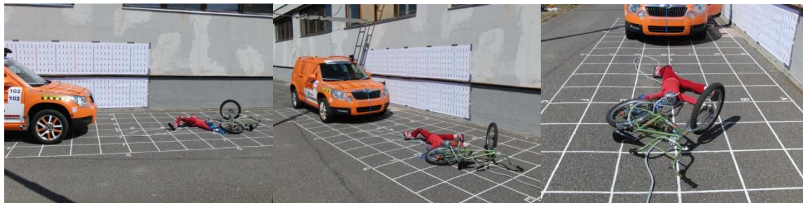
Obr. 16 - konečná poloha objektů po kolizi - test č. 102 - fotodokumentace.
