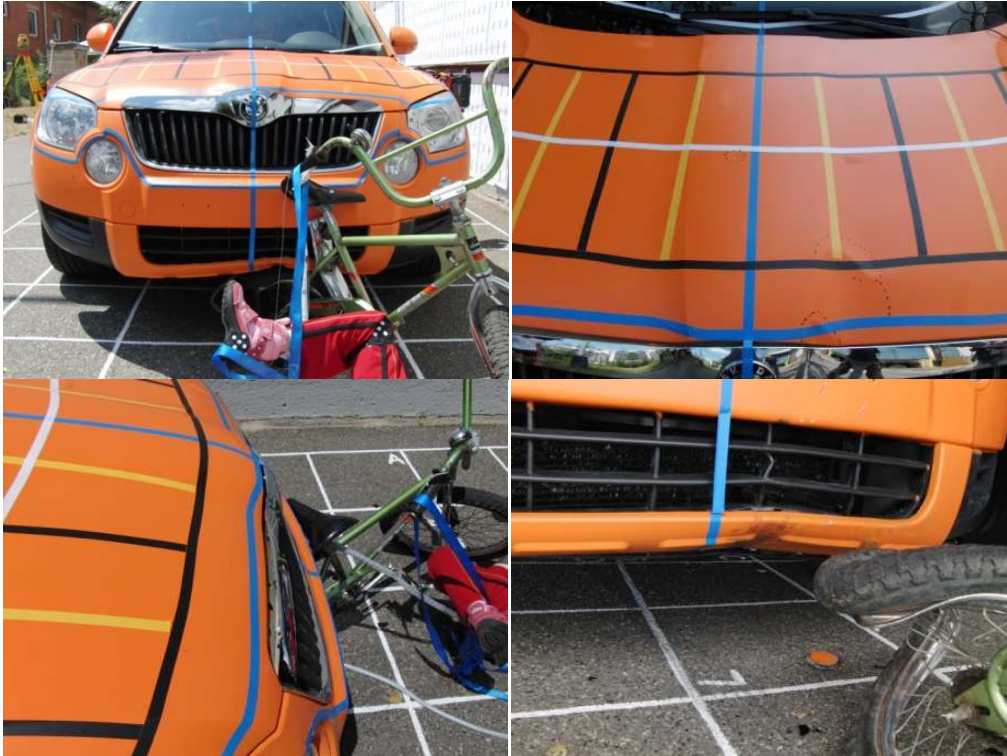
Obr. 29 - poškození automobilu po kolizi – test č. 302.
