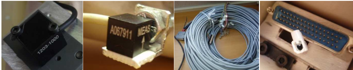
Obr. 4 - snímače zrychlení a kabeláž (zleva): tříosý akcelerometr 1203, jednoosý akcelerometr 1201, kabeláž s konektory RJ50, konektor DD50 v hrudníku figuríny.
