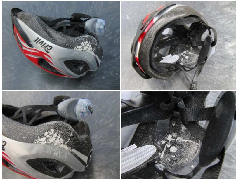
Obr. 23 – poškození cyklistické přilby po kolizi – test č. 202
