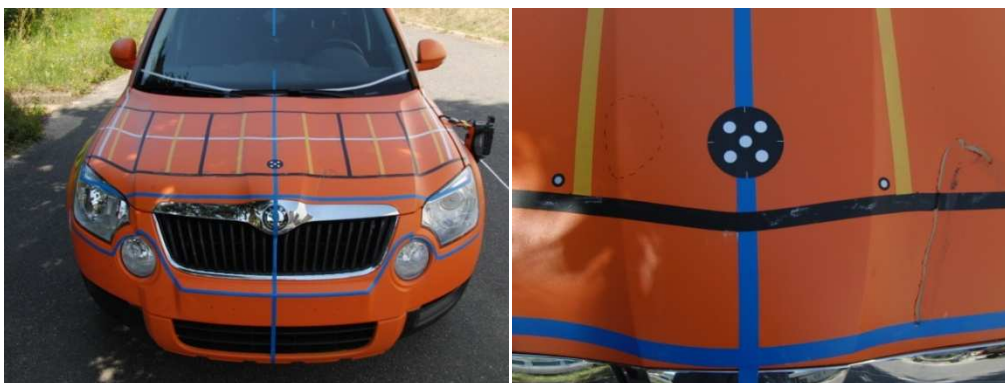
Obr. 17 – poškození automobilu po kolizi – test č. 102.
