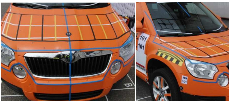
Obr. 8 - zóny na předí automobilu dle testovacího protokolu EuroNCAP pro testování impaktorem dětské hlavy (modře shora: referenční linie náběžné hrany kapoty, horní referenční linie nárazníku, vertikálně osa y; černě horizontálně: WAD 1 1000 a WAD 1500; bíle horizontálně: WAD 1250, černě a žlutě vertikálně: rozdělení vzniklých zón do dvanácti ekvivalentních testovacích polí), na obr. vpravo modře boční referenční linie.
