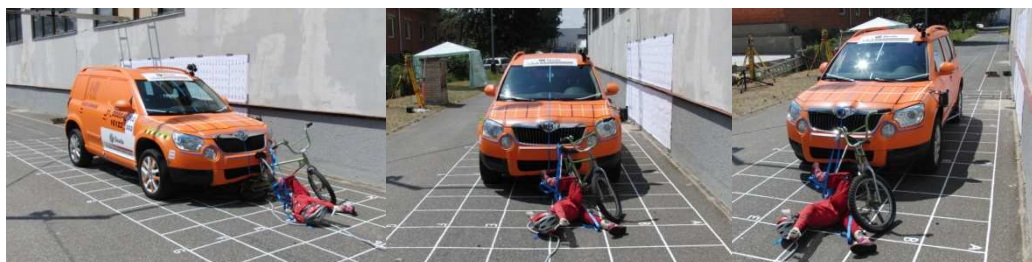
Obr. 28 - Konečná poloha objektů po testu č. 302 - fotodokumentace.
