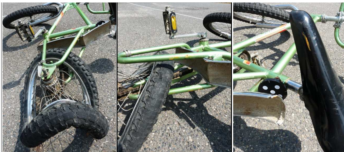
Obr. 30 – poškození jízdního kola po kolizi – test č. 302.
