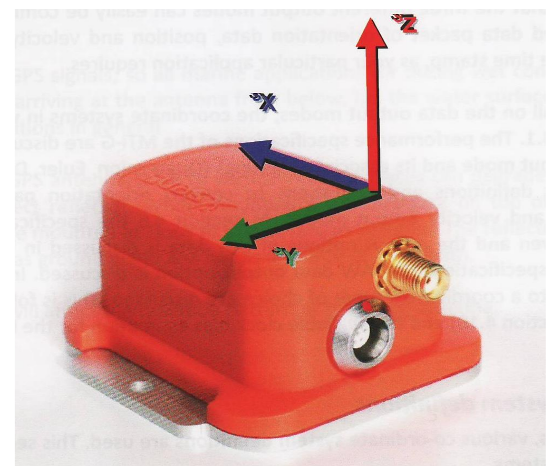
měřicí přístroj XSENS MTi-G
